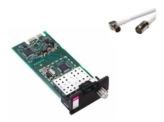
Das DVB-C Modul befindet sich hinter dem Kabelnetzstecker und wird werkseitig in den Fernseher eingebaut und kann in der Regel nicht nachgerüstet werden.
